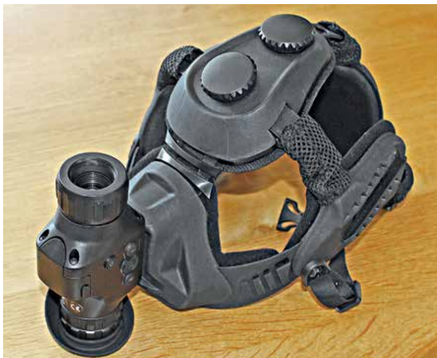
Originální NATO montáž byla sice vyprodaná, ale takhle vypadá nasazení termovizního handsfree monokuláru Odin T320 na civilním postroji pro hlavu
