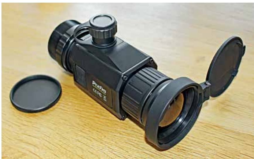
Termovizní předsádka PixFra vychází z termovizního puškohledu, nasazuje se před klasickou denní optiku
